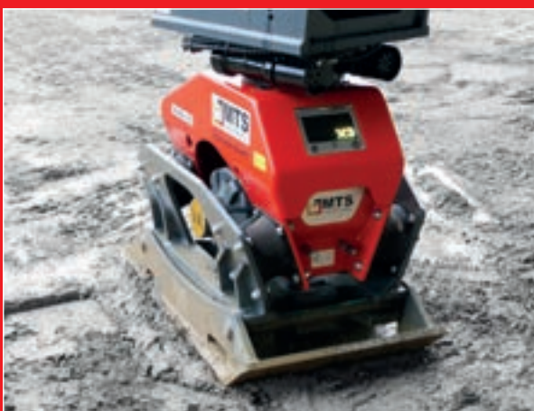
Verbesserten Boden verdichten
