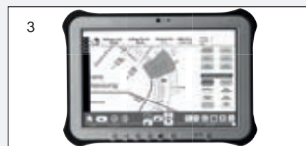
3D-Daten auf Baggerrechner
