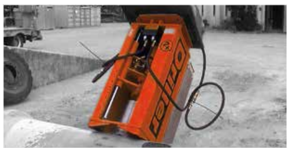
Herstellung eines Rohranschlusses
