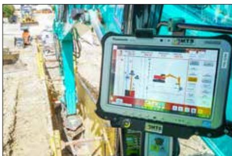
Das MTS-NAVI übersetzt das Bauausführungsmodell in präzise Vorgaben für die Bauausführung.
