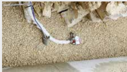
Messung der Beschleunigung unter und neben dem Rohr
