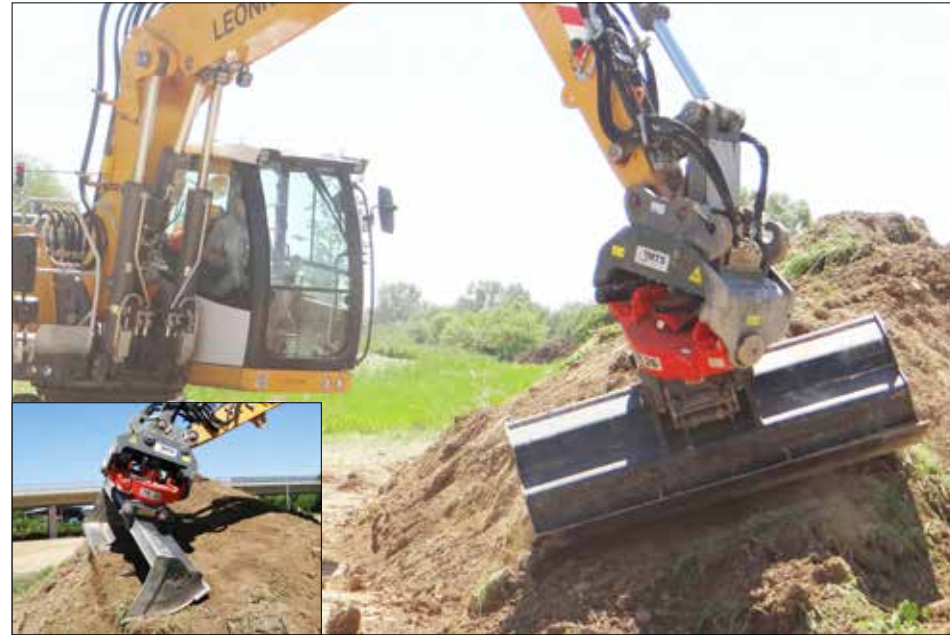
Robuste Sandwichlösung mit niedriger Bauhöhe: MTS-Tiltrotator
