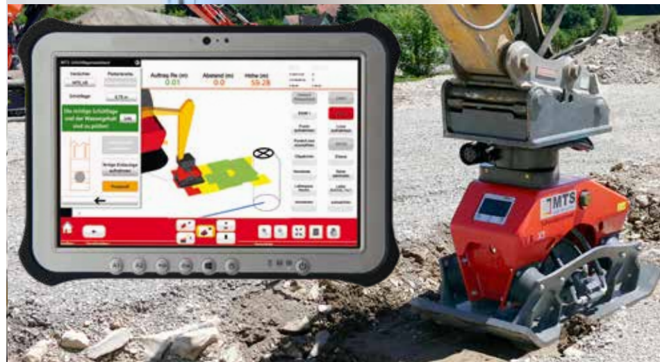
Die Bodenarterkennung ist ein wichtiger Baustein der raumfüllenden Verdichtungskontrolle (RFVK).
