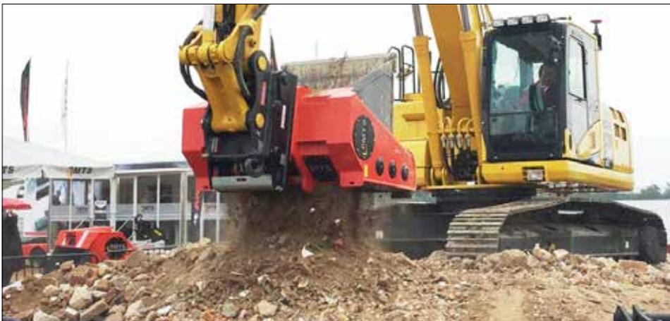
Der MTS-Bodenrecycler punktet beim Homogenisieren von Boden und als Problemlöser für kleinere Arbeiten.
