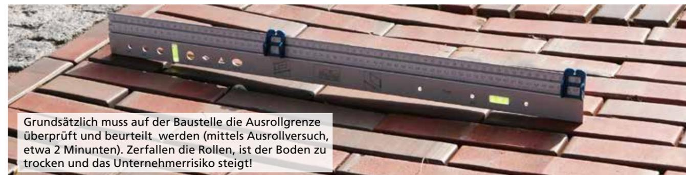
Grundsätzlich muss auf der Baustelle die Ausrollgrenze überprüft und beurteilt werden (mittels Ausrollversuch, etwa 2 Minuten). Zerfallen die Rollen, ist der Boden zu trocken und das Unternehmerrisiko steigt!
