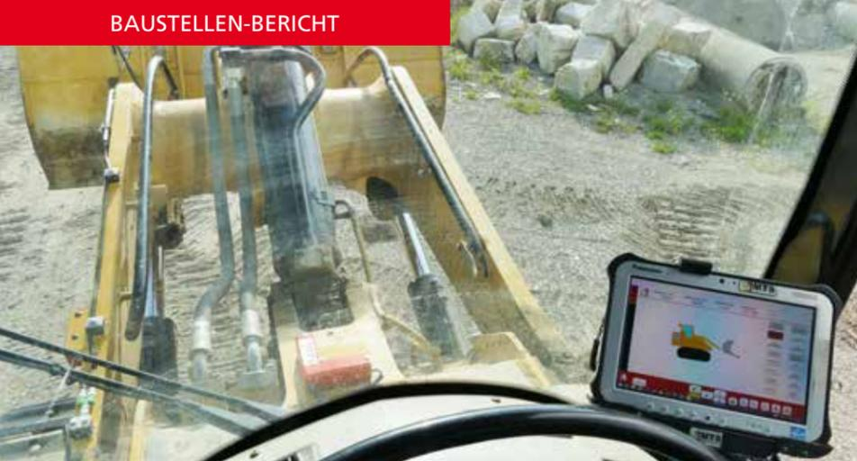
Aufgrund der positiven Erfahrungen mit der 3D-Baggersteuerung von MTS ließ die Lupold Straßen- und Tiefbau GmbH den Prototypen eines Ladaraupenzeigesystems aufbauen.
