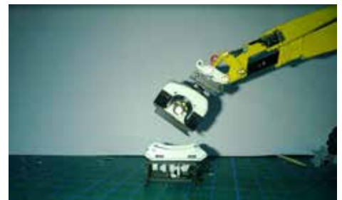
Das Ankoppeln funktioniert via Klick-Mechanismus
