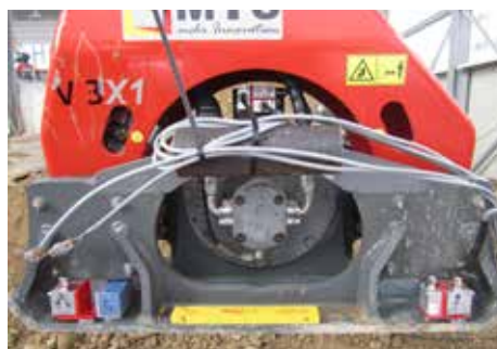
Ausstattung des Anbauverdichters mit Sensoren
