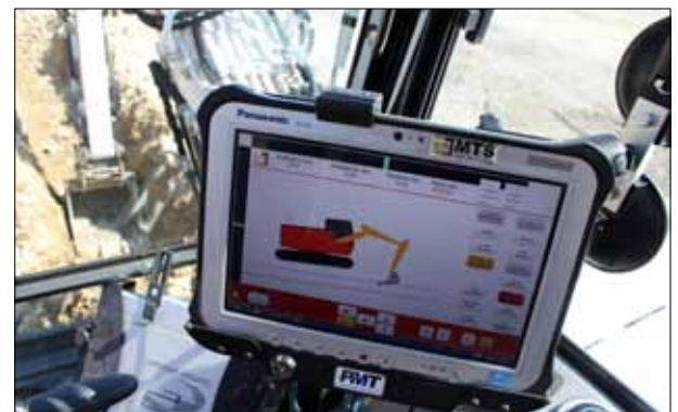
Seitenansicht der Kanalhaltung im MTS-NAVI
