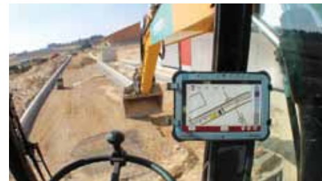
Einzigartig: die Doppelfunktion des Rechners, der im Bagger und am Rover benutzt werden kann
