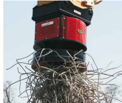
Der EGLI-Magnet hilft beim Aussortieren von freigelegten Schrottanteilen und beim Absammeln liegen gebliebener Eisenteile
