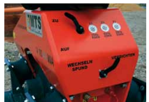
Frequenz und Schlagkraft lassen sich dank X3-Schaltstufe regulieren
