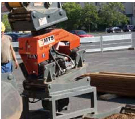
In Sekundenschnelle von der Grundplatte auf eine Spundwandklemme wechseln
