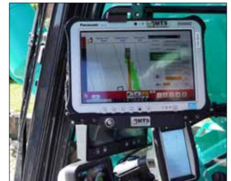
Erfassung der As-Built-Daten und Rückführung ins 3D-Modell
