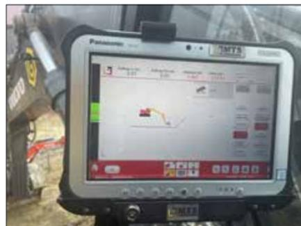
Auf dem Display des MTS-Navi sieht der Baggerfahrer jederzeit die Lage und Höhe der Löffelschneide.
