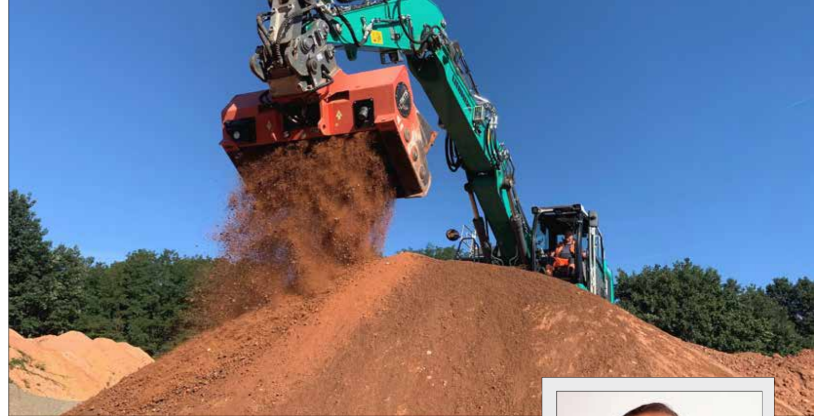
Der extrem bindige Buntsteinsand im saarländischen Homburg stellt besondere Anforderungen an die Siebtechnologie. Mit der entsprechenden Anpassung der Schlegelsätze läuft der MTS-Bodenrecycler mit gewohnt hoher Leistung.
