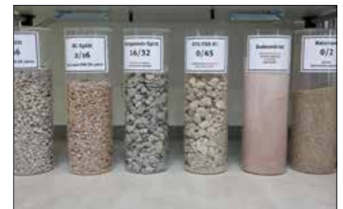
Materialproben der über 40 hergestellten Qualitäts-Recycling-Baustoffe aus Kirchheim.
