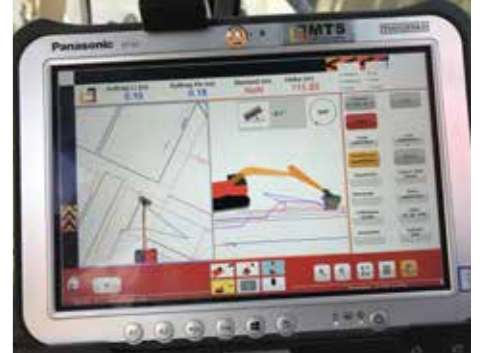
Die Splitscreen-Ansicht vom MTS-NAVI unterstützt den Geräteführer beim Abziehen des Planiegefälles.
