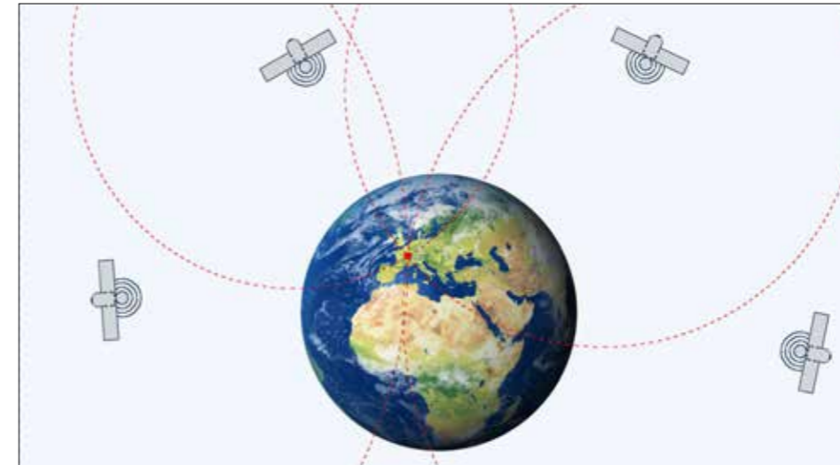
Abb 1: Das Grundprinzip der Satellitennavigation: Die Position auf der Erde wird durch die Messung der Entfernung zu den jeweiligen Satelliten bestimmt.
