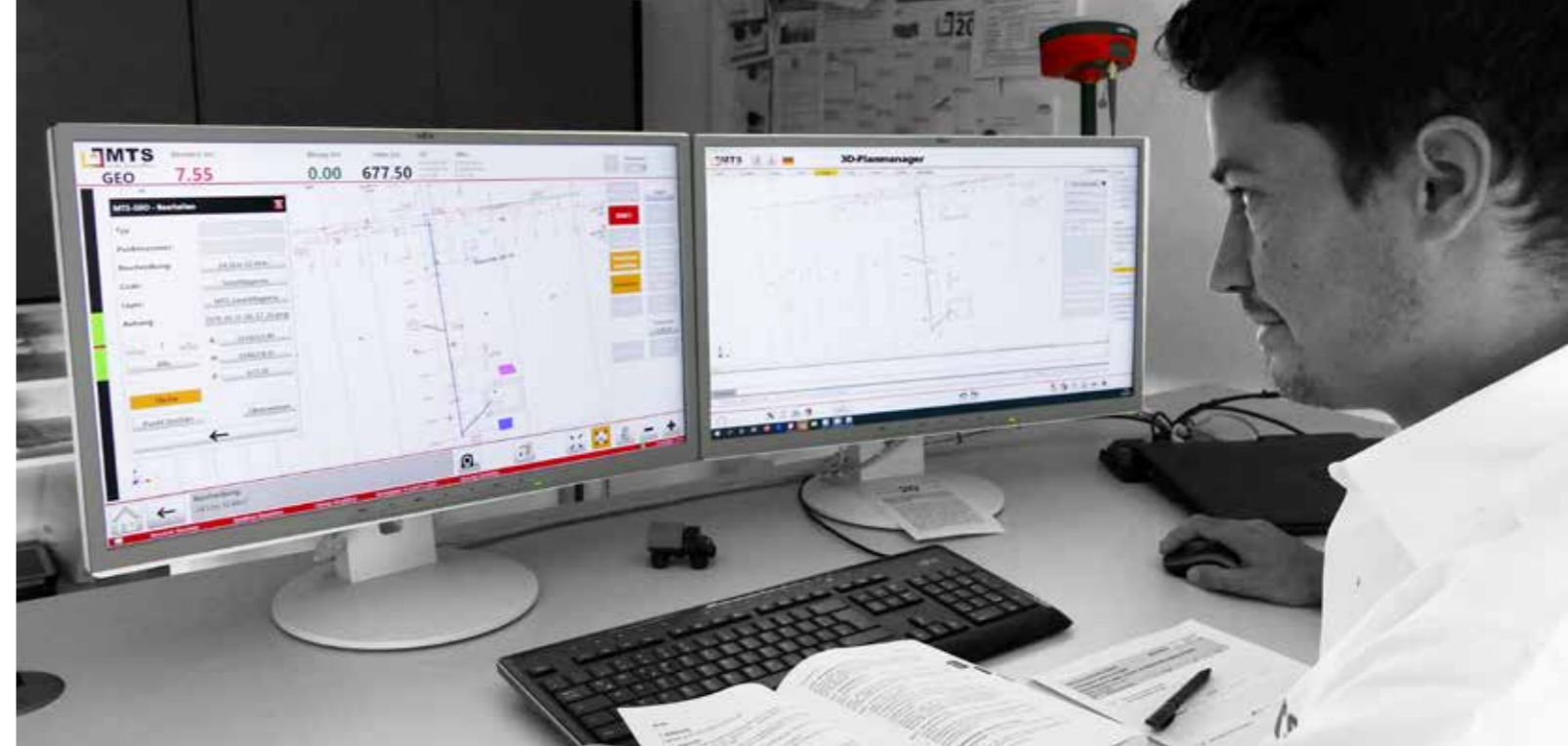
Punkte, Linien und digitale Geländemodelle lassen sich mittels 3D-Planmanager schnell und einfach für die Ausführung mit 3D-Maschinensteuerungen vorbereiten.
