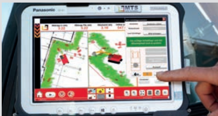
Kontrolle der Verdichtungsqualität im MTS-NAVI
